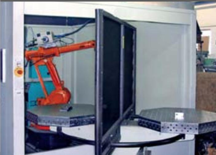
due tavole da saldatura 3D in funzionamento scambiabile nella cella robotizzata Fattibile per un carico massimo ottimale del robot con preimpostazione.
