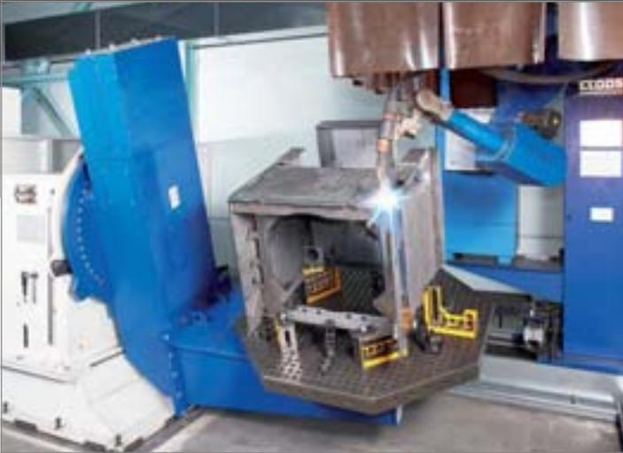
3D tavola da saldatura Okto ed accessori montato su posizionatore ad L
