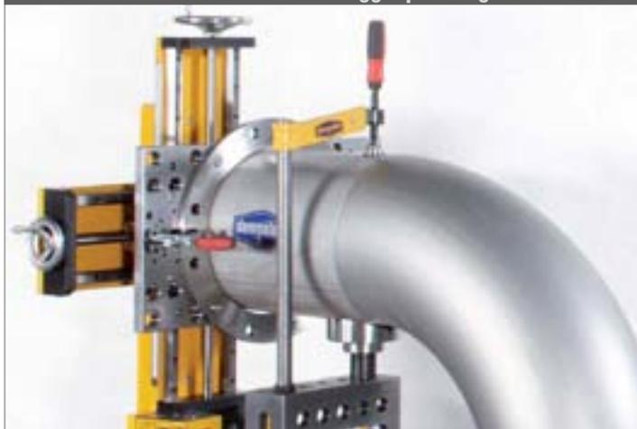
Demmeler in funzione: Lastra di fissaggio per flange
