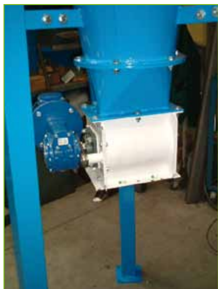
Rotocella per lo scarico del materiale abbattuto
