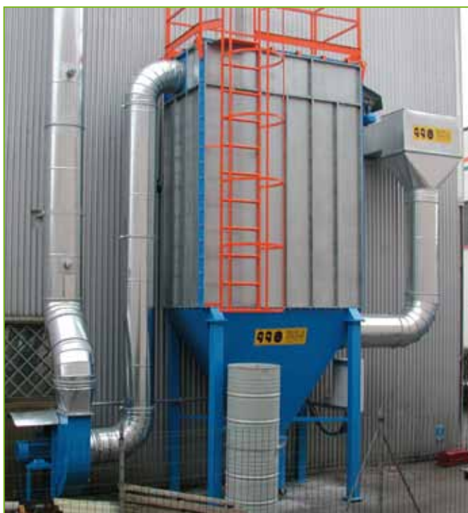
POLJET FZ. Realizzazione con pannelli in lamiera zincata
