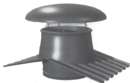
Conversa a doppia pendenza, passo 177, inclinazione 28,6%. (da Ø 400 a Ø 600)
