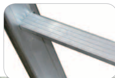
Piolo a trapezio ribordato e saldato con anima tornita
