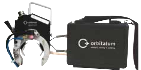
ORBIWELD TP 250 con alimentazione filo freddo esterno KD
