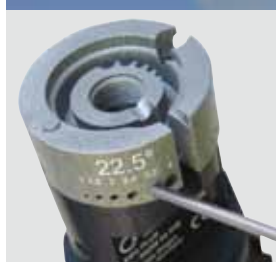
Affilatura: 4 angoli e 6 diametri diversi
