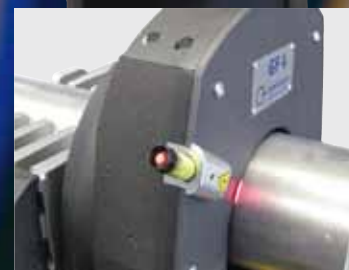
Puntatore laser integrato per l'individuazione dei punti di taglio sul tubo.
